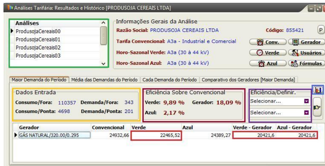
Figura 1.4 – Análise feita utilizando gerador a gás natural no horário de ponta
