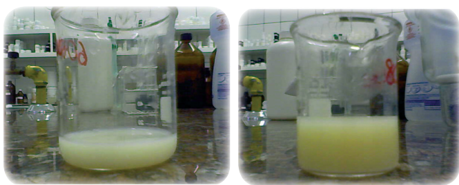
Figura 4: Emulsões com tensoativo natural e sintético; A, lecitina + tween 60; B, lecitina + tween 80.
